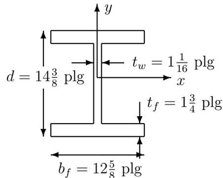
La altura total de la columna es de 14 pies, y sólo tiene arriostramiento lateral en sus extremos superior e inferior. Se requiere encontrar los esfuerzos admisibles por:
